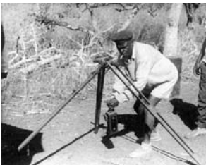
Medição de uma base (fotografias das Missões Geográficas de Angola e Moçambique)
