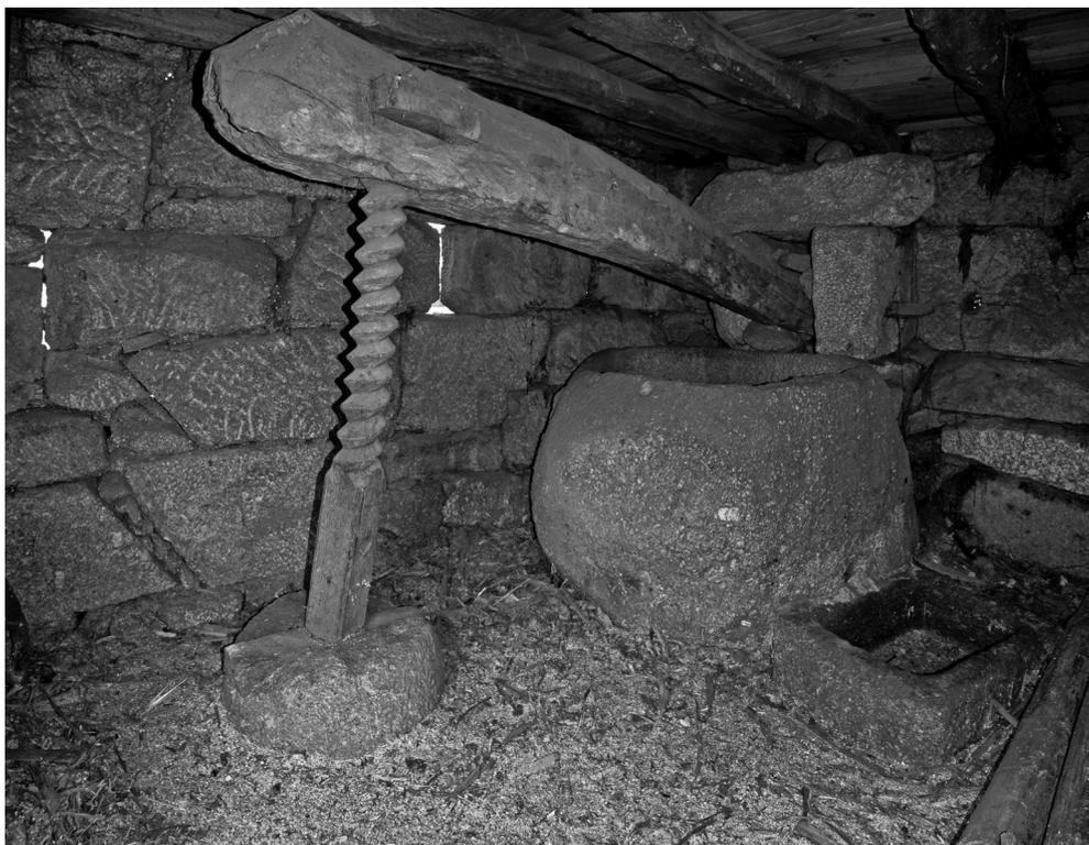
**Fig. 6** – Instalação do lagar e prensa
