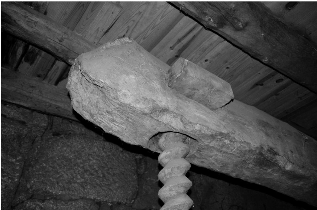
**Fig. 8** – Extremidade da prensa com o fuso montado
