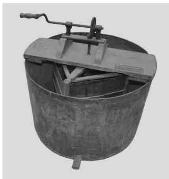
Fig. 15 - Material apícola para o melário. 1 - Desoperculador Bingham (SEQUEIRA 1895) 2 - Desoperculador a frio fabricado em Rio Mau 3 - Prensa (SEQUEIRA 1985) 4 - Extractor unilateral Gariel (SEQUEIRA 1895) 5 - Extractor bilateral (CASTEL-BRANCO s/d) 6 - Extractor unilateral fabricado em Rio Mau
