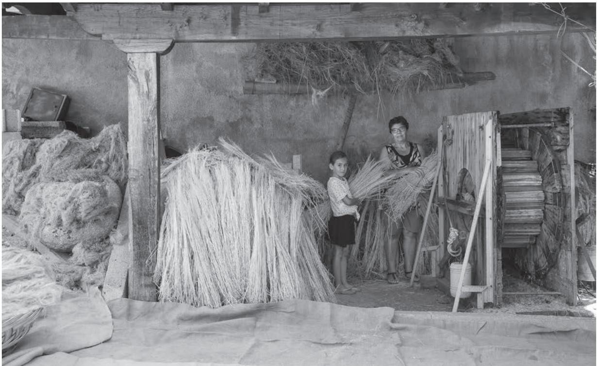
**Fig. 11:** Cutilinho (Pedraça): engenho de linho tradicional accionado por motor eléctrico
