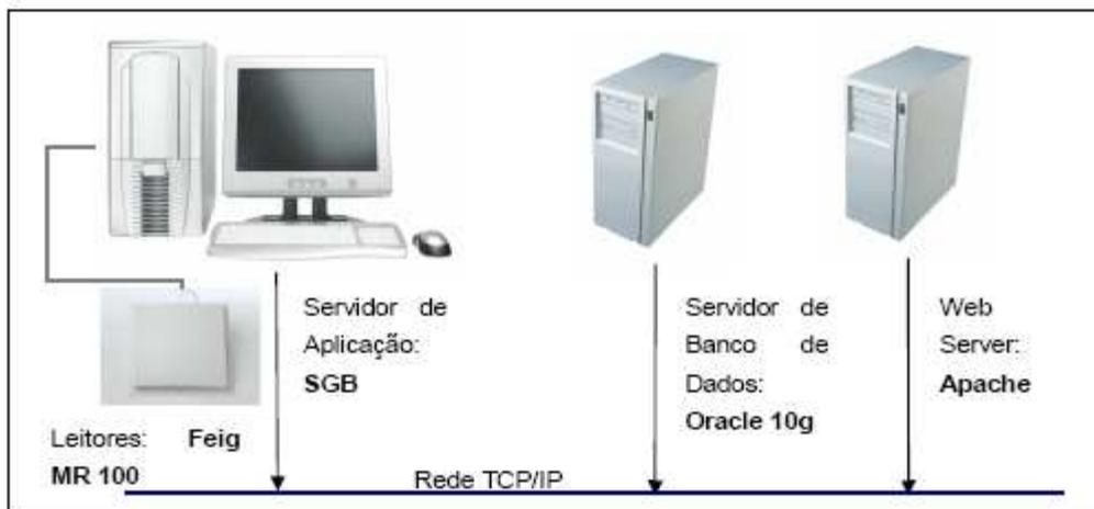
**Figura 6:** Arquitetura dos equipamentos para construção do SGB
