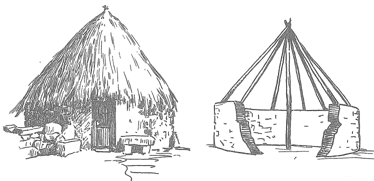
Fig. 2 — Casa de habitação dos Cabeçudos (Marvão), com a armação do telhado e a coluna central da mesma casa.
